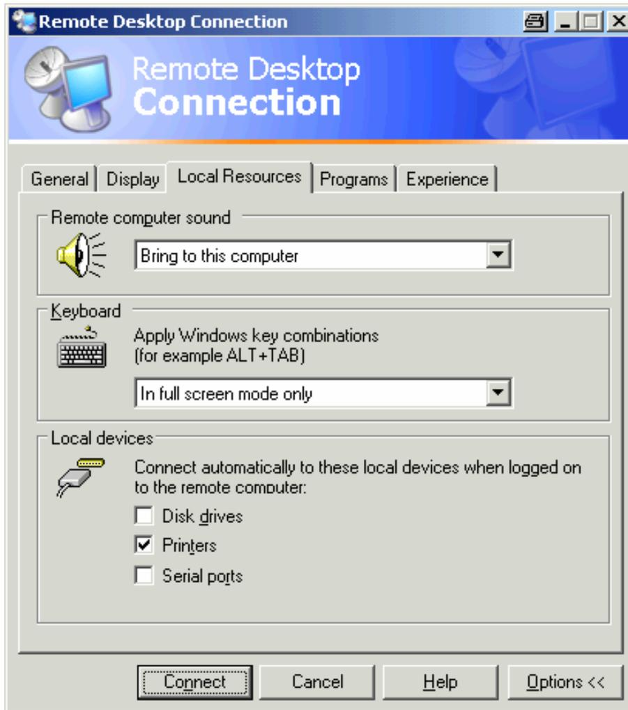
7. Wird der Zugriff des R&S FSL auf Laufwerke des Steuerrechners benötigt (z. B. um Einstellungen zu speichern oder um Dateien vom Steuerrechner auf den R&S FSL zu kopieren), ist die Option **Disk drives** zu aktivieren. Windows XP ordnet dann Laufwerke des Steuerrechners, z. B. Netzwerklaufwerke, zu.
